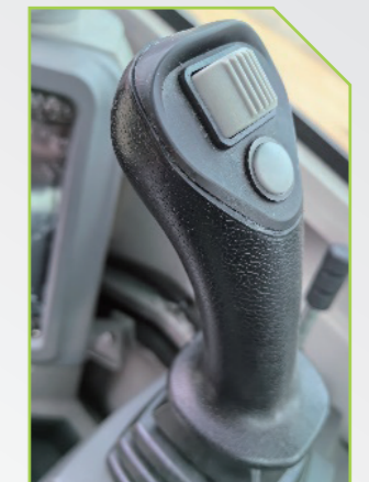
ELEKTRISCHER PROPORTIONAL-JOYSTICK FÜR EINE HOCHKONFIGURIERTE MASCHINE
