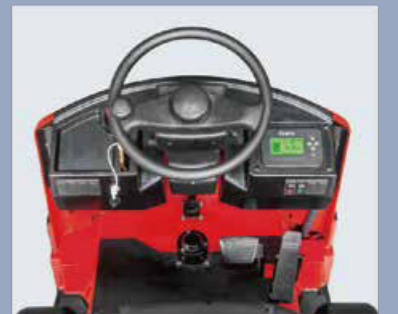
Modernes Gliederungsdesign mit LCD-Instrument und USB-Ladeanschluss
