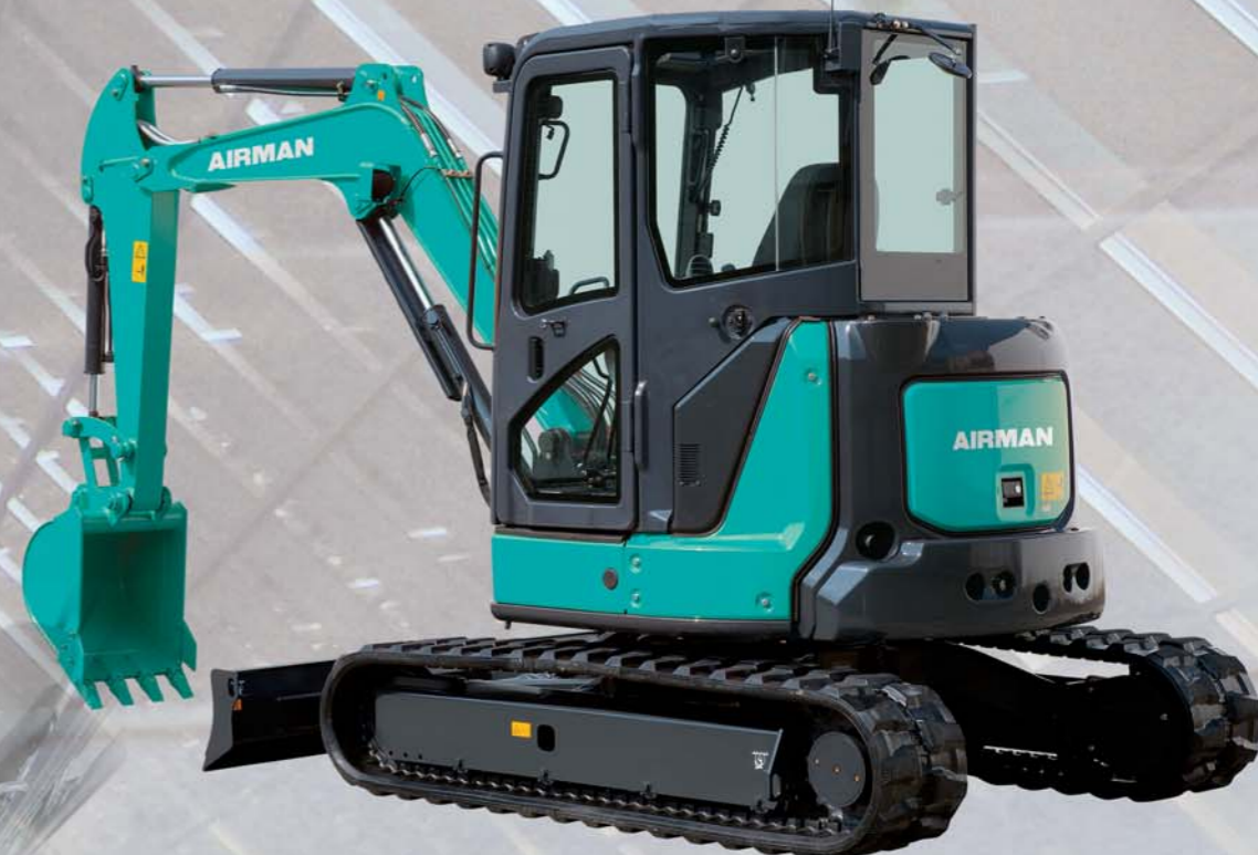
AX48u-6A Einsatzgewicht 4,770kg Kapazität 0.11m 3 Gummiketten, 4-Säulen Schutzdach
