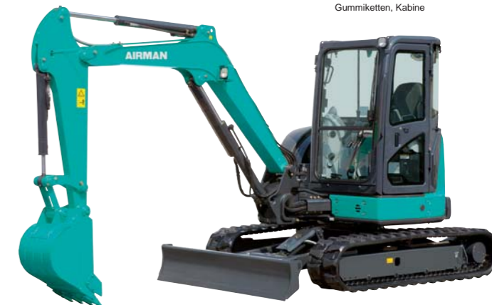
AX55u-6A Einsatzgewicht 5,210kg Kapazität 0.14m 3 Gummiketten, Kabine
