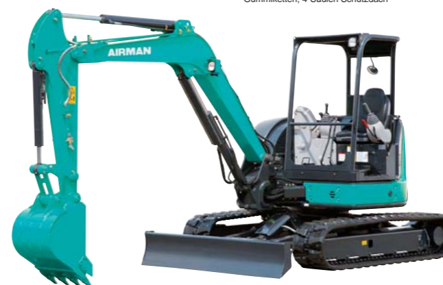
AX48u-6A Einsatzgewicht 4,770kg Kapazität 0.11m 3 Gummiketten, 4-Säulen Schutzdach
