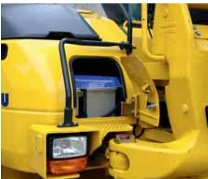
Vom Boden aus erreichbare Batterie
