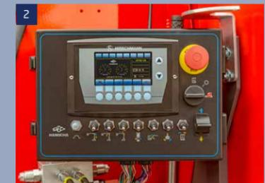
Auch mit dem intuitiv zu bedienenden Steuerkasten unten am Auslegerbaum lassen sich sämtliche Aktionen durchführen.
