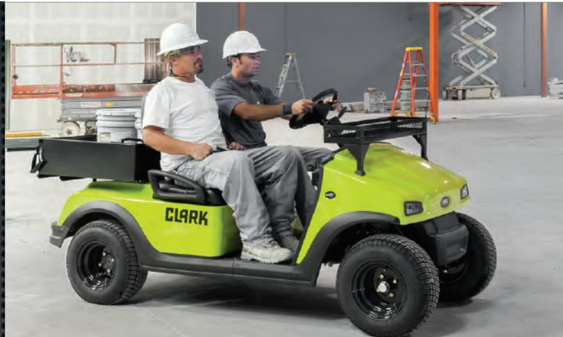
Der CBX ist ein kompaktes Nutzfahrzeug, das sich perfekt für die Beförderung leichter Güter und den komfortablen Transport von bis zu vier Insassen eignet. Ein optionales Fahrzeugdach bietet zusätzlichen Wetterschutz.
