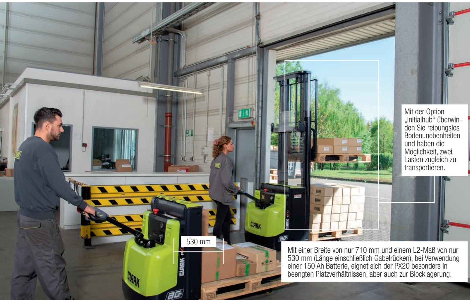
Mit der Option „Initialhub“ überwinden Sie reibungslos Bodenunebenheiten und haben die Möglichkeit, zwei Lasten zugleich zu transportieren.
