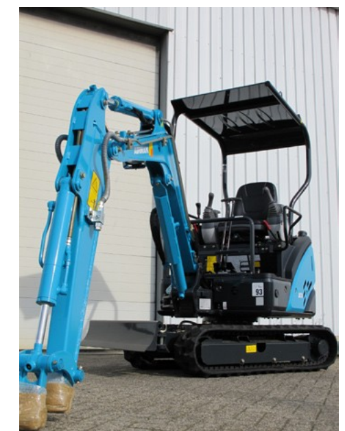
Der AX18-4 ist mit einem Drei-Punkt-Canopy ausgestattet das sich durch entfernen von nur Sieben Schrauben leicht demontieren lässt.
